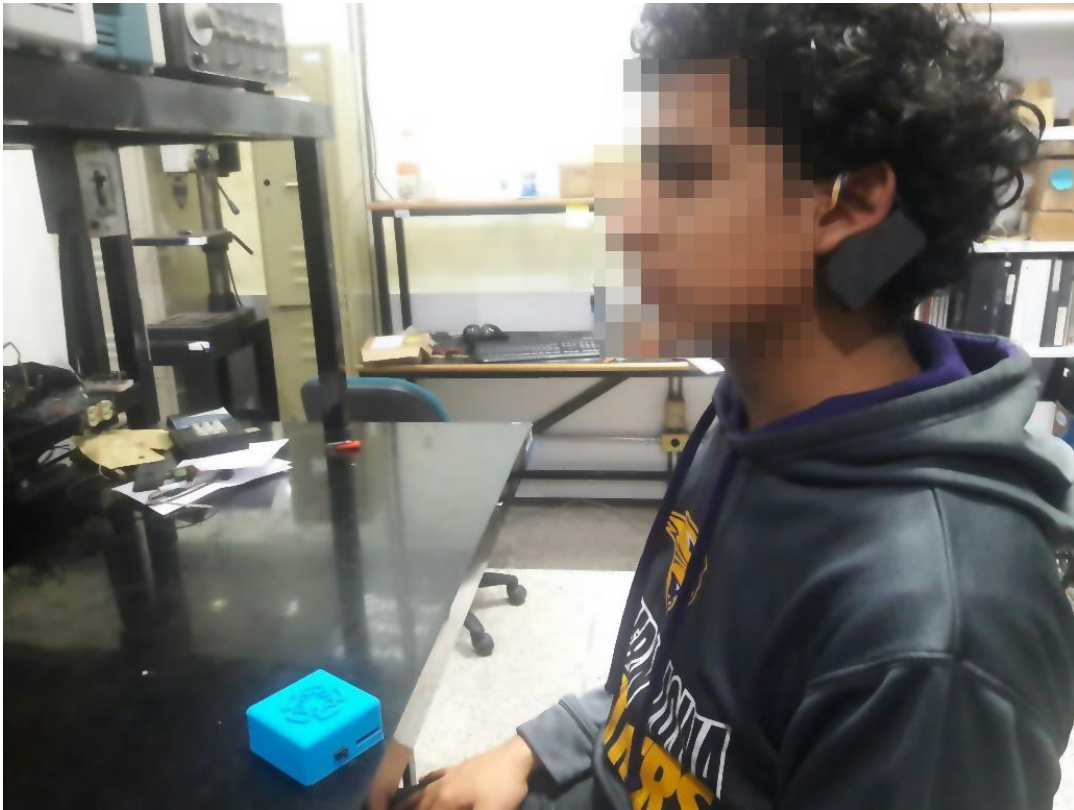
Fig. 27 Medición in situ de las temperaturas interna y externa para la determinación de la temperatura corporal media.
