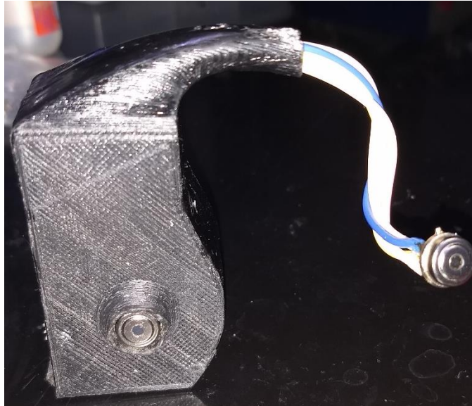
Fig. 22 Prototipo final del sistema termómetro- transmisor de datos.
