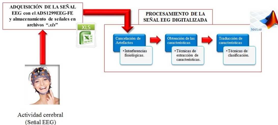
Figura 4.1 Diagrama a bloques del sistema de adquisición y clasificación de señales electroencefalográficas para la identificación de movimientos reales de las extremidades superiores.
