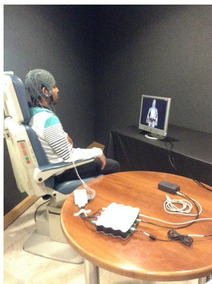
Figura 5.4 Posición del sujeto de prueba durante la adquisición de la señal con el equipo g.BCIsys.
