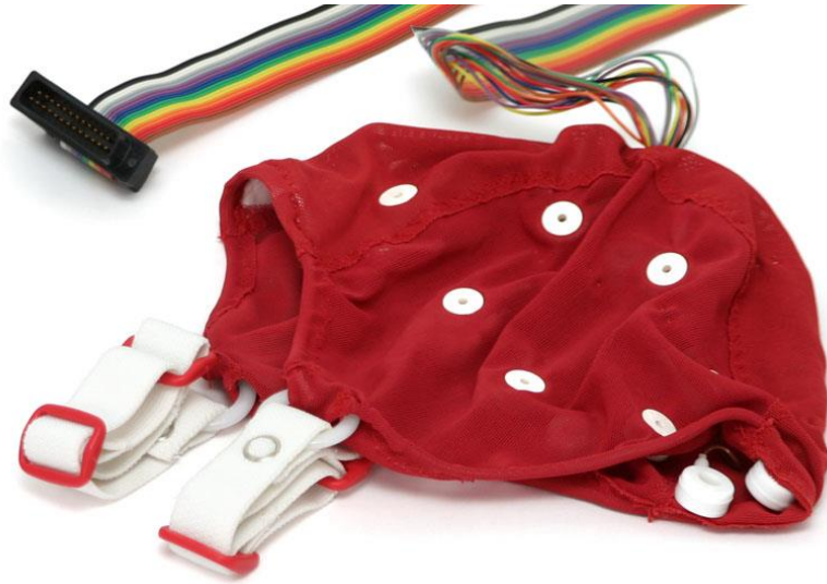
Fig. 3. 3. Gorra con electrodos de Ag-AgCl de Electro-Cap ®
