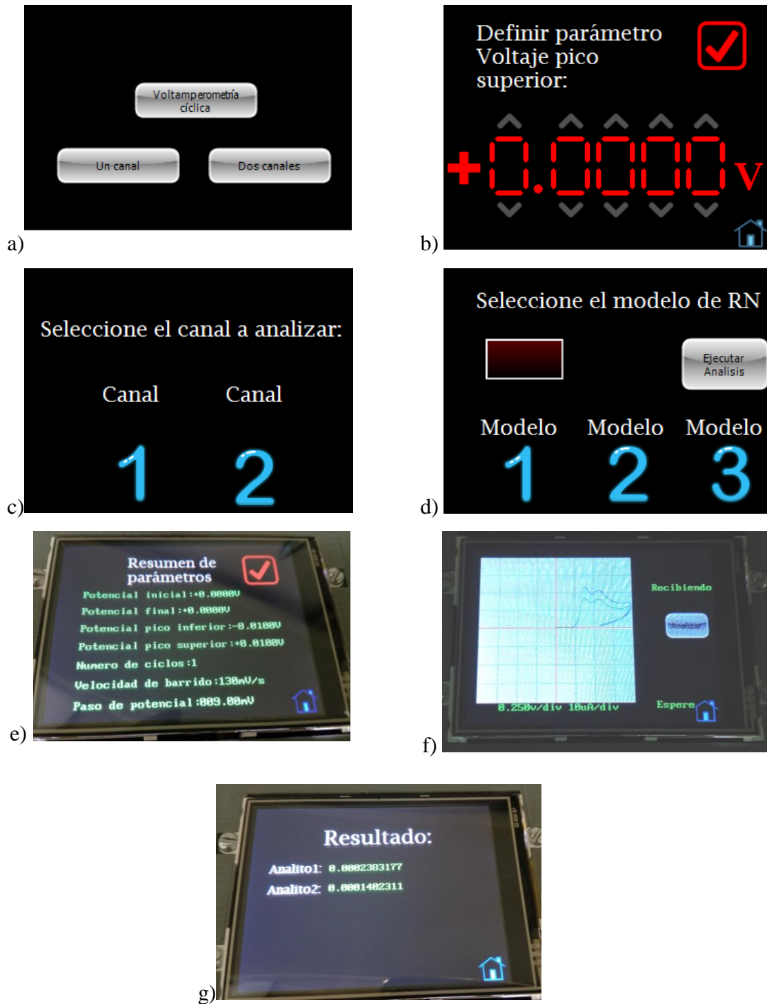
Fig. 3.8 Pantallas de la interfaz gráfica. a) Pantalla principal, b) Menú de definición de parámetros, c) Menú de selección de canal a analizar (solo modo bipotenciostato), d) Menú de selección de MLP, e) Resumen de parámetros del barrido, f) Pantalla para el despliegue de la señal obtenida, g) Pantalla de Resultados de las concentraciones de los analitos analizados con el modelo MLP.
