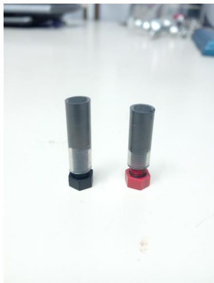
Fig. 3.17 Electrodo de trabajo de pasta de carbono con nanotubos de carbono y partículas de oro.
