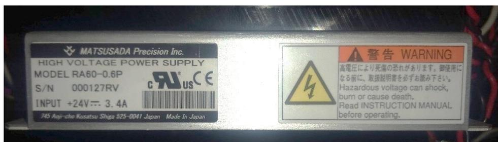
**Fig. 30 Fuente de alimentación conmutada aislada de alta frecuencia.**
