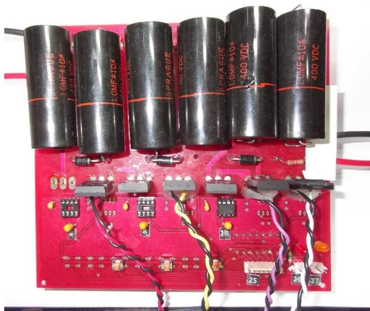
**Fig. 41 Tarjeta de potencia la cual contiene los transistores MOSFET de alta potencia, encargados de la conmutación entre la configuración de carga y descarga de un generador Marx.**
