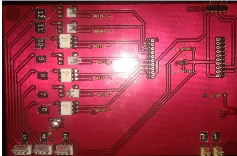
**Fig. 38 Tarjeta de control los conectores enumerados indican 1) alimentación de 5 V, 2)Alimentación de 12 V, 3-5) Conector de comunicación, 6-11) Interfaz de control de potencia de los MOSFET.**
