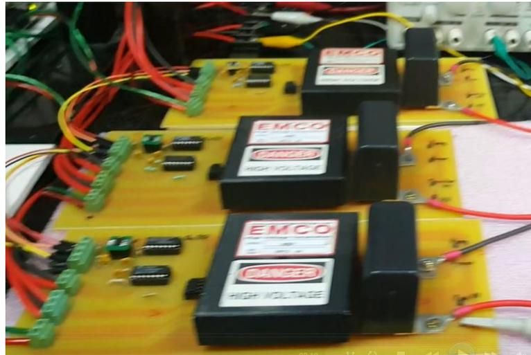
**Fig. 24 Conexión en serie de los módulos de  $V = 1500$  @  $A = 300mA$ , con tarjeta aislada y fuente de alimentación independiente.**
