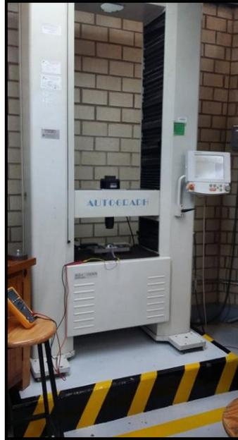
**Fig. 24. Máquina Universal AG-1 Shimadzu – 100kN.**
