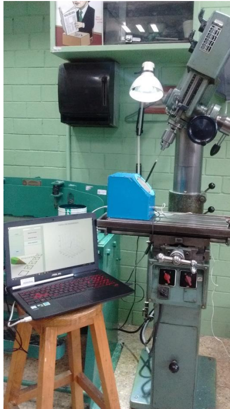
Fig. 17. Equipo montado en la fresadora, realizando pruebas de calibración.
