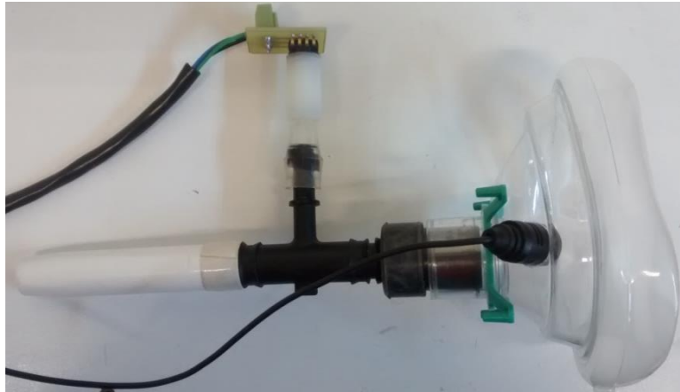
Fig 10. Sistema de acople con sensores de presión para el registro de la señal de voz.
