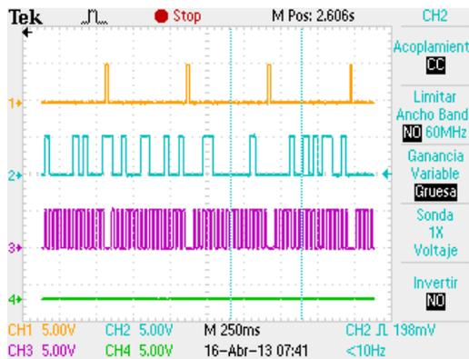
Fig. 3-4 Señales de control para la comunicación al AD5932. Señal amarilla FSYNC, la azul SDATA, la magenta señal de reloj SCLK.
