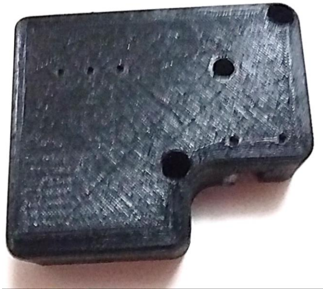
Fig. 45 Carcasa parte derecha manufacturada en impresión de prototipos rápidos 3D.
