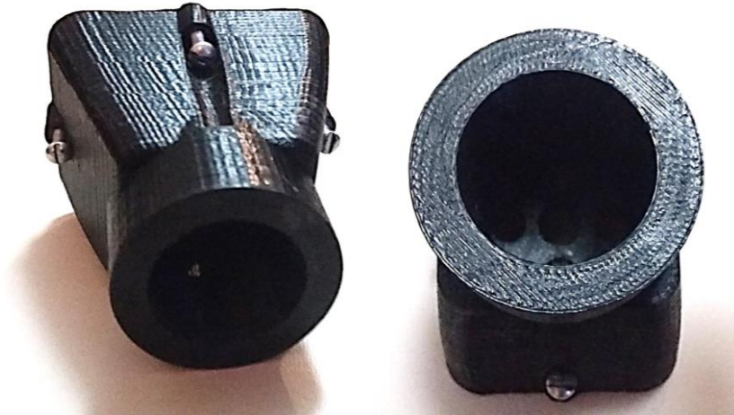
Fig. 46 Manufactura pieza guía en impresión de prototipos rápidos 3D.
