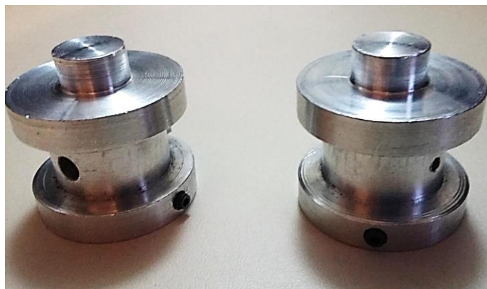
Fig. 42 Poleas manufacturadas para integrar al mecanismo.
