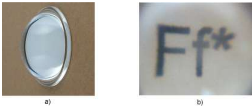
Fig. 3.11.- a) Lente convexa aumento 10x b) Imagen obtenida usando lente convexa
