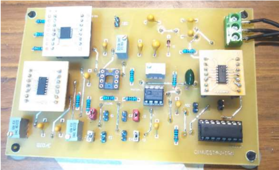
Fig. 35 Placa de aplicación de la señal de excitación y detección de impedancias.
