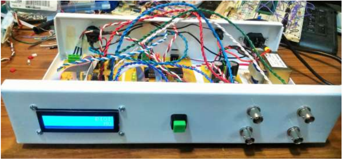
Fig. 41 Conexión de las placas en el gabinete, vista lateral.
