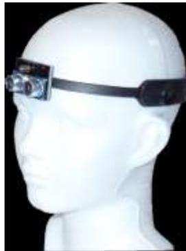
Figura 14. Diadema ceñida en la cabeza. La diadema va sujeta a la cabeza, con los sensores en la parte frontal como se observa en la figura. En la parte posterior se encuentra la fuente de voltaje con su respectivo interruptor, que provee el suministro energético necesario para hacer funcionar los sensores.
