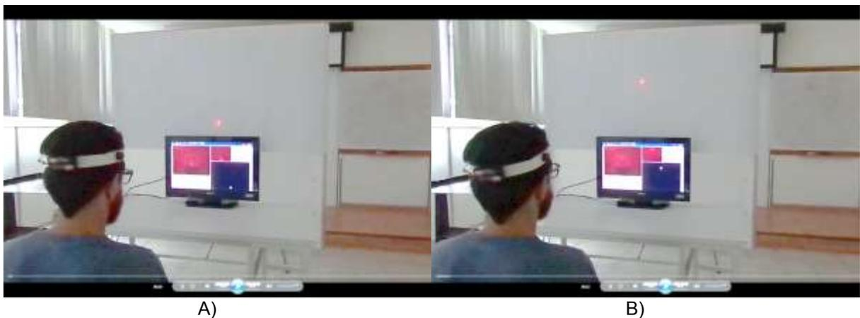
Figura 25. Registro de movimientos voluntarios cefálicos. En este ejemplo, se aprecia en la figura a) que el haz de rayo láser se encuentra en la parte central inferior del monitor, para esta posición, debe efectuarse un movimiento de flexión, en la figura b) se observa el puntero en la parte central superior del monitor, para ello el usuario debe realizar el movimiento de extensión. Ambas fotografías proceden del mismo video, la barra del reproductor indica la secuencia de las fotografías.
