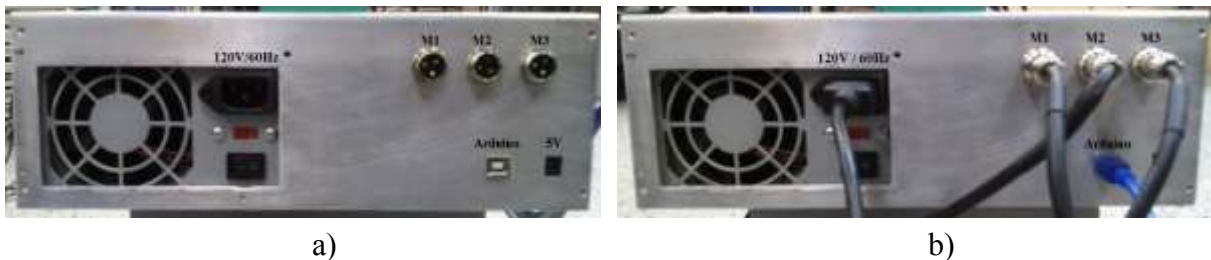
Fig. 3.29 Vista posterior de la caja de conexiones para la alimentación a 120V de CA, los tres motores del seguidor (M1, M2 y M3) El cable USB del Arduino, alimentación del Arduino a 5V de CC. a) Sin conectar, b) con conexiones.
