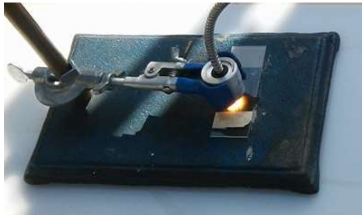
Fig. 4.13 Imágenes de la radiación solar concentrada y transportada mediante una fibra óptica, aplicándose sobre una muestra de óxido de grafeno.
