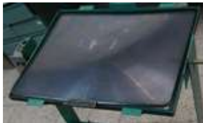
Fig. 3.1 Lente de Fresnel empleada para coleccionar y concentrar la luz solar, montada sobre el seguidor
