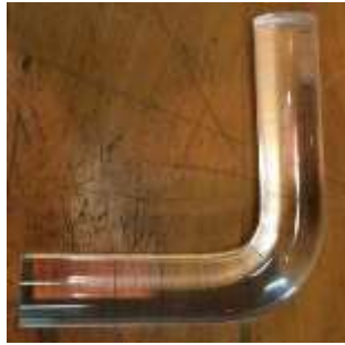
Fig. 3.30 Barra de acrílico de prueba doblada con un ángulo de 90^\circ
