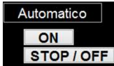
Fig. 3.22 Botones de encendido y apagado del posicionamiento automático del seguidor solar
