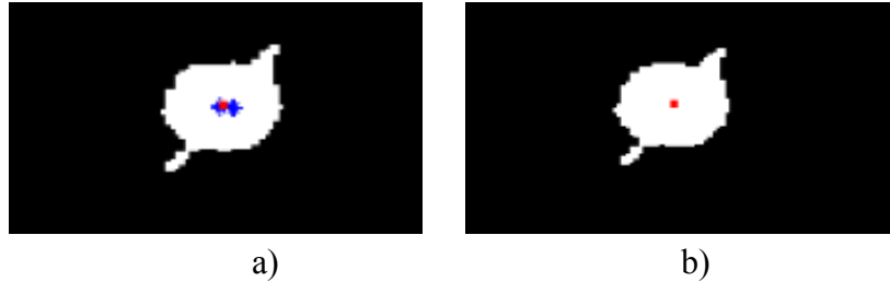
Fig. 3.20 Imagen binarizada del sol. a) Cuando su centroide aún no coincide con el centroide objetivo, b) Cuando su centroide ha coincidido con el rango de aceptación (centroide objetivo)
