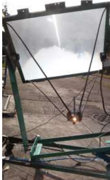
Fig. 4.5 Radiación solar concentrada en la parte central del lente, a una distancia de 55 cm de su superficie.
