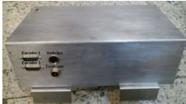
Fig. 3.28 Vista anterior de la caja de circuitos electrónicos mostrando los conectores para los dos encoders, los dos interruptores y el termopar
