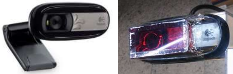
Fig. 3.6 Cámara Web empleada como sensor para identificar la posición del sol
