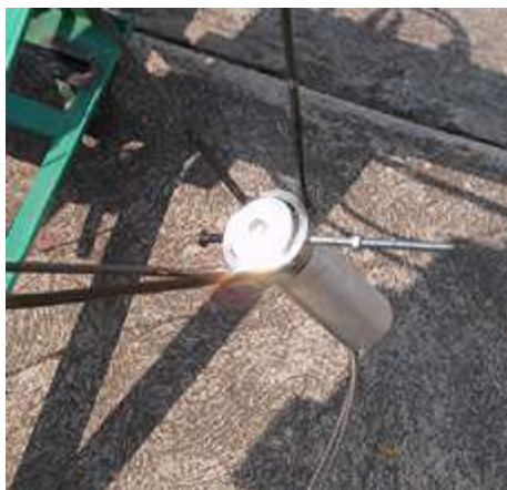
Fig. 4.4 Radiación solar concentrada a unos cuantos centímetros del punto deseado.
