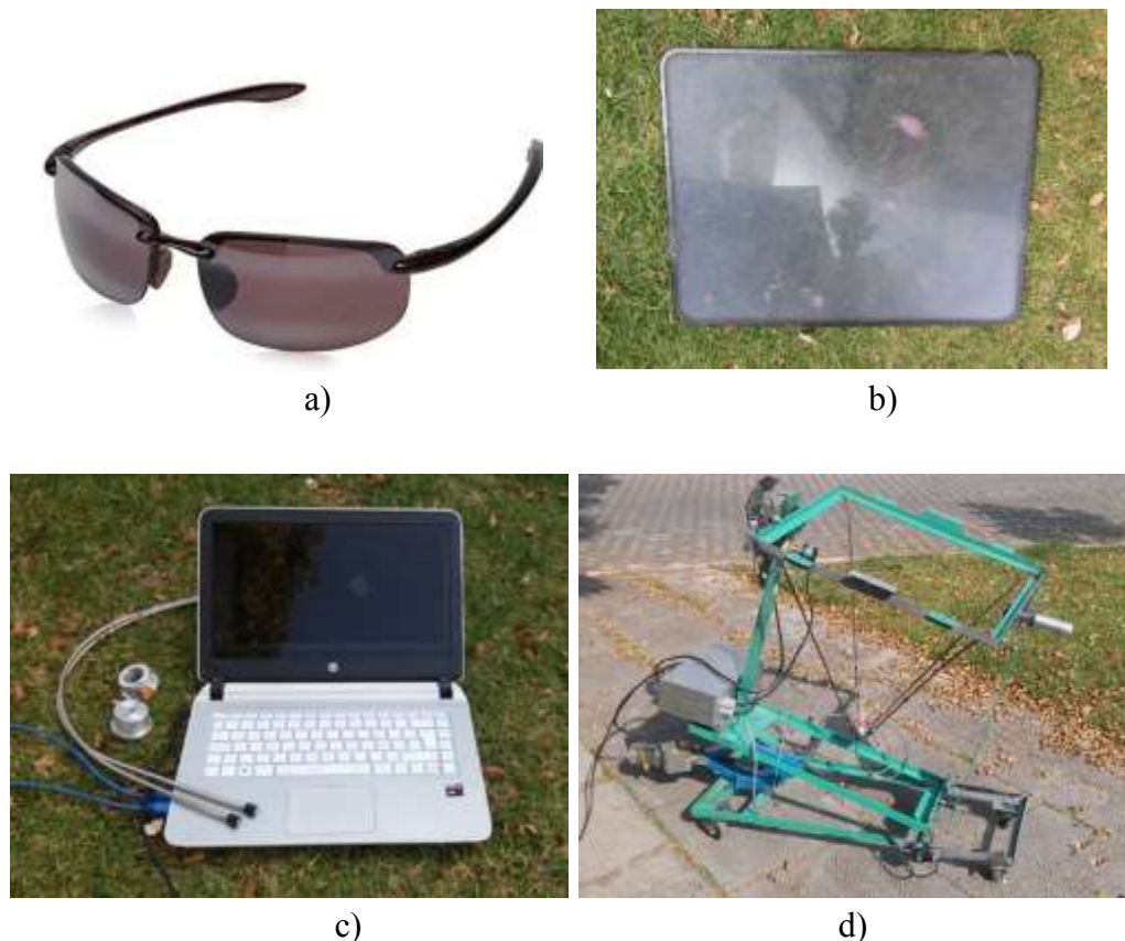
Fig. 4.1 Equipo y componentes principales utilizados en la realización de las pruebas, a) Gafas de sol b) Lente de Fresnel, c) Laptop y fibra óptica, d) Estructura del seguidor solar.
