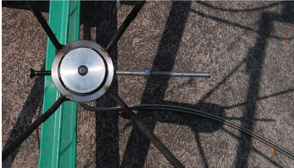
Fig. 3.5 Sistema de acoplamiento de la radiación solar concentrada y una fibra óptica
