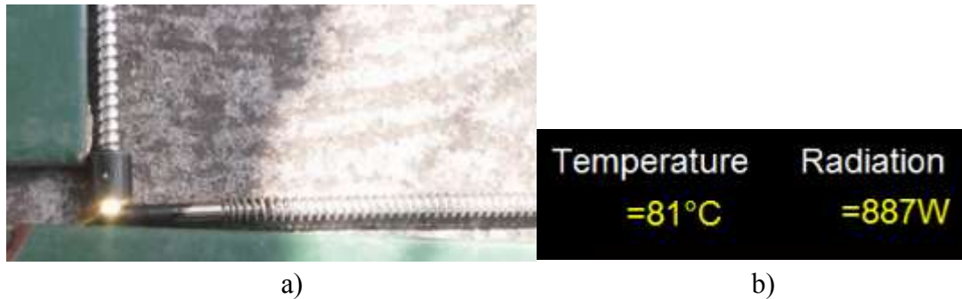
Fig. 4.11 a) Medición de temperatura de radiación solar concentrada por uno de los extremos de la fibra óptica, b) Valor de temperatura en grados Celsius ( ^{\circ}\text{C} ) alcanzada por la radiación solar y valor de radiación solar sin concentrar en \text{W}/\text{m}^2 .
