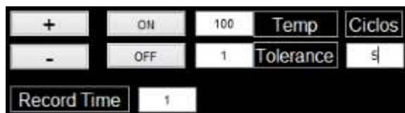
Fig. 4.7 Interface de control de temperatura manual y automático
