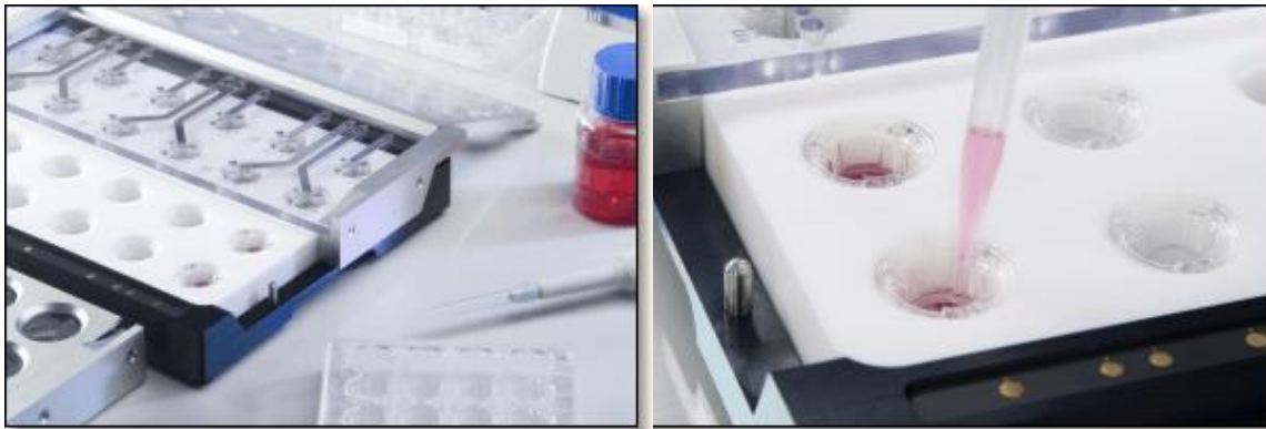
Fig. 2.19. Arreglo multipozo del instrumento CellZscope Nano analytics [72].
