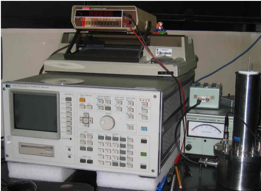
Figura 32. Analizador de parámetros de semiconductor HP 4145B, con el cual se realizaron las mediciones en los HEMTs.
