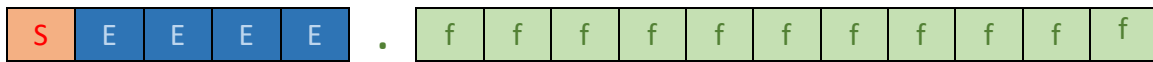
Figura 4. 5 Vector de bit. S representará negativos o positivos binarios; E, números enteros binarios y f la parte fraccionaria.
