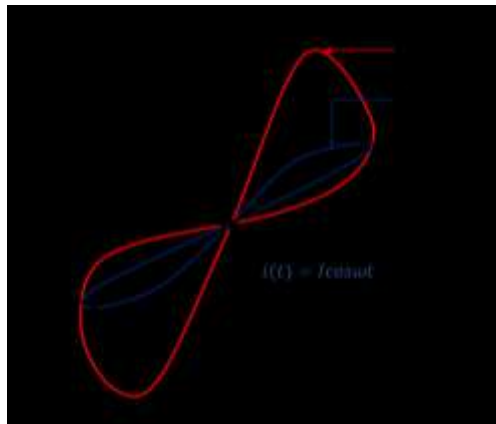
Figura 1.5 Característica de la respuesta corriente-voltaje de un sistema memristivo.
