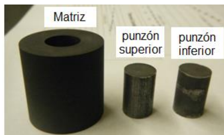
Figura 3.5 Dado, Dado, donde fueron colocadas las diferentes composiciones de la aleación en polvo Bi_{1-x}Sb_x
