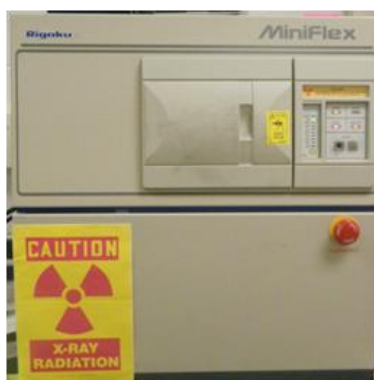
Figura 3. Equipo de Rayos-x, ocupado para la caracterización de los materiales termoeléctricos tipo-N y tipo-P
