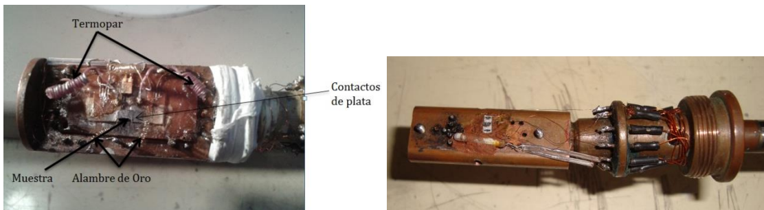
Figura 3.15. a) Porta muestras del equipo de Medición Coeficiente Seebeck IIM., b) Esquema físico del portamuestra para medir resistencia IIM UNAM.
