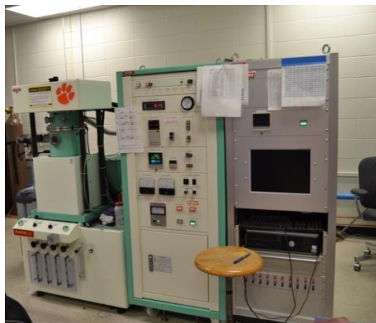
Figura 3.4 Equipo Dr. SINTER SPS-515S, donde, se llevó a cabo el proceso de sinterizado. CAML Universidad de Clemson.
