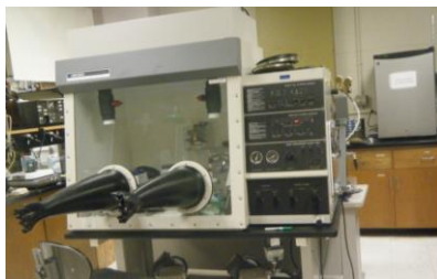
Figura 1 Cámara de guantes LABCONCO con atmosfera de argón
