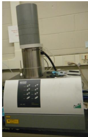
Figura 8. Equipo de Laser Flash Nnetzsch Ifa457, para la medición de difusividad térmica.
