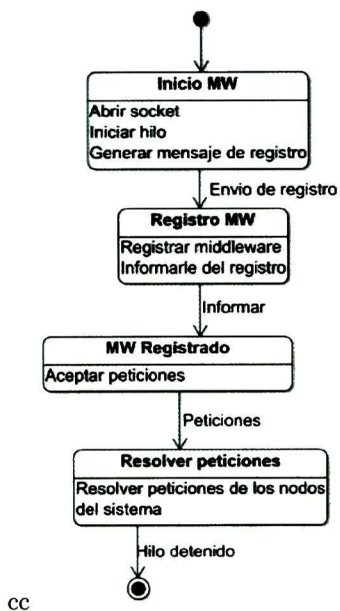
Figura 4.3: Inicio de un MW Diagrama de estados que muestra los pasos necesarios para que un MW inicie.
