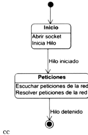
Figura 4.2: Inicio middleware principal Diagrama de estados que muestra los pasos necesarios para que el MW principal inicie.
