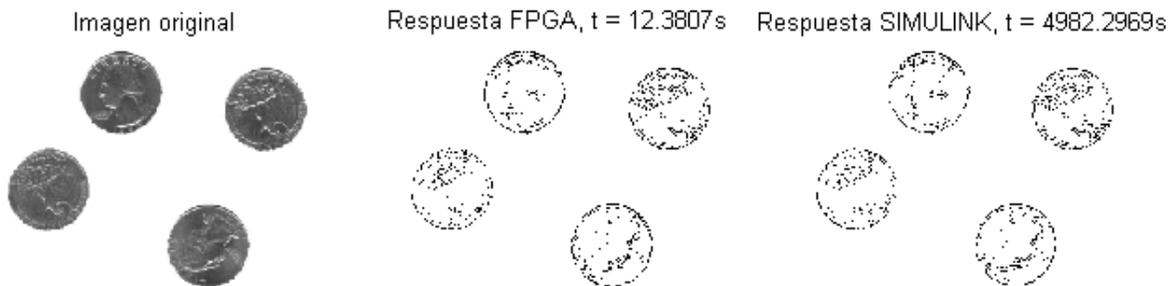
Esta imagen procesada tiene un tamaño de 263x267 píxeles en escala de grises, y como observamos, fue más rápido el procesamiento con el FPGA que la simulación. Mientras el procesado dentro del FPGA tomó 12.3807 segundos, la realizada con SIMULINK tomó 4982.2969 segundos. Además, se encontró una correlación entre ambas imágenes de 0.9998, lo que quiere decir que son muy parecidas las imágenes.
