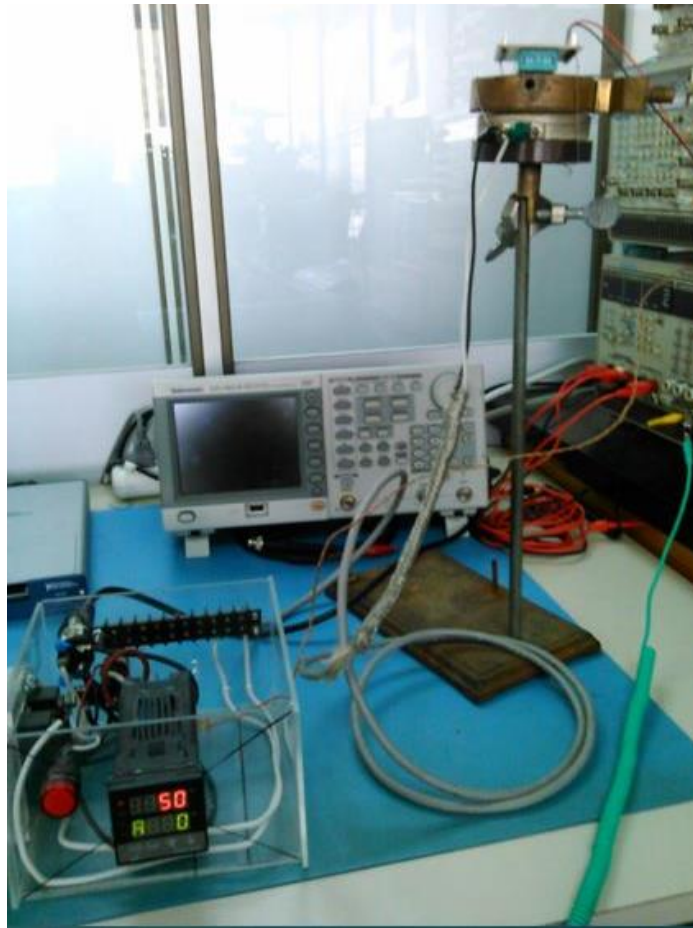
Figura 4.2: Montaje para la medición de R(T)
