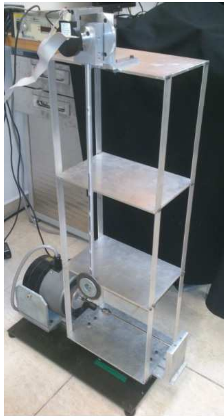
Figura 4.36: Sistema primario con absorbedor tipo pendular
