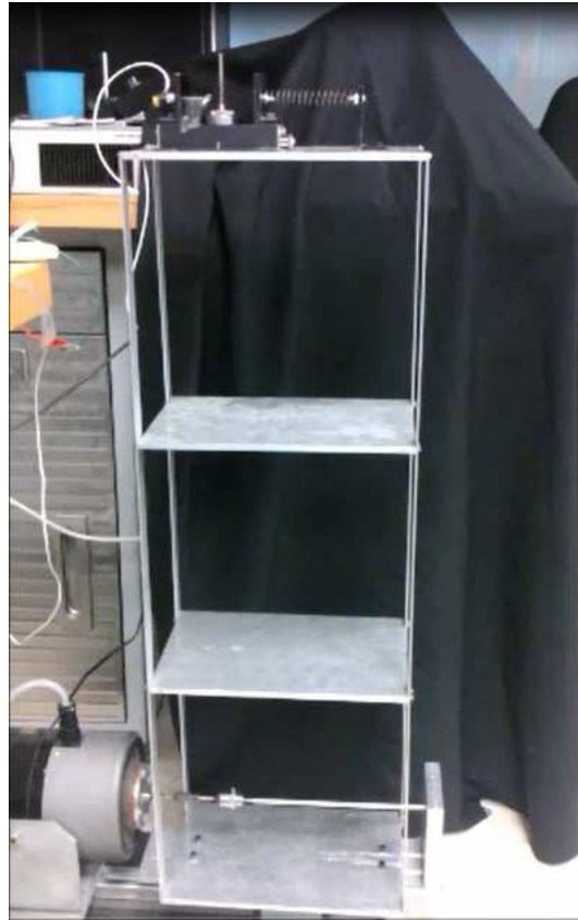
Figura 4.18: Estructura tipo edificio con absorbedor tipo masa-resorte-amortiguador.
