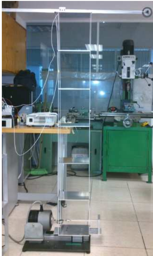
Figura 3.2: Estructura tipo edificio de 6 niveles (sistema primario de 6 gdl) con absorbedor autoparamétrico tipo viga en cantilever.
