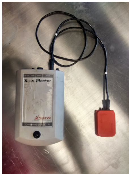
Figura 3.5: X-bus Master y Unidad de Medición Inercial.
