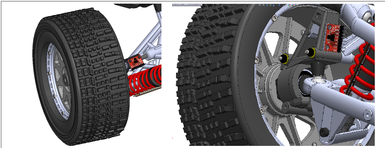
Figura 3.2.2: Montaje de acelerómetros.
