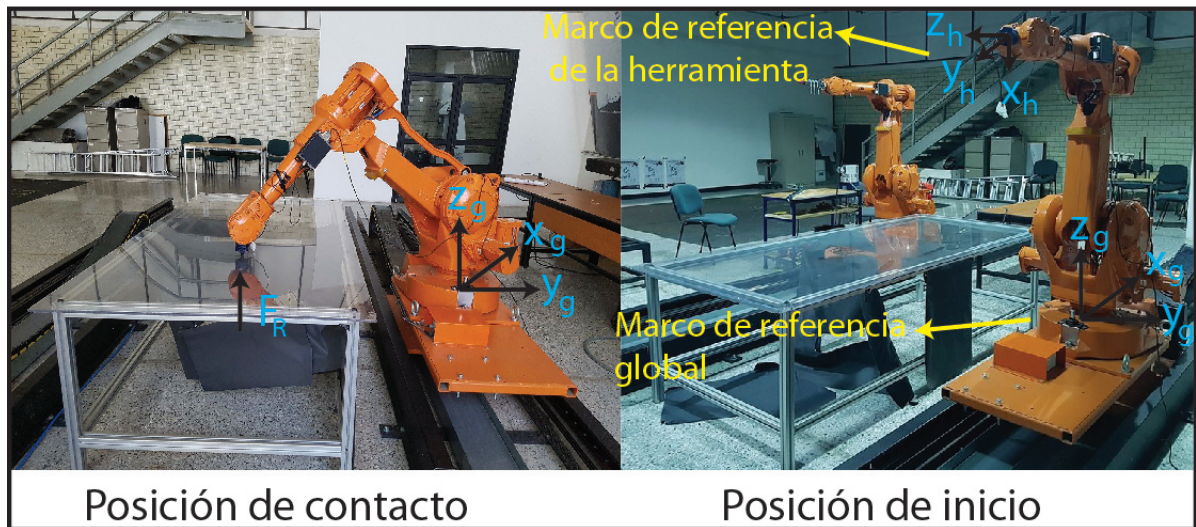
Figura 5.1: Robot industrial IRB 2400 ABB en estado inicial y en estado de interacción.
