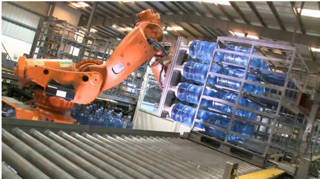
Figura 1.1: Robot IRB 6600 de la marca ABB realizando tareas pick and place [27].
