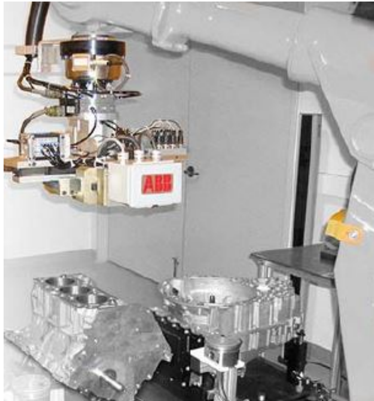
Figura 1.2: Ensamblaje de un motor de automóvil con un robot industrial ABB [28].
