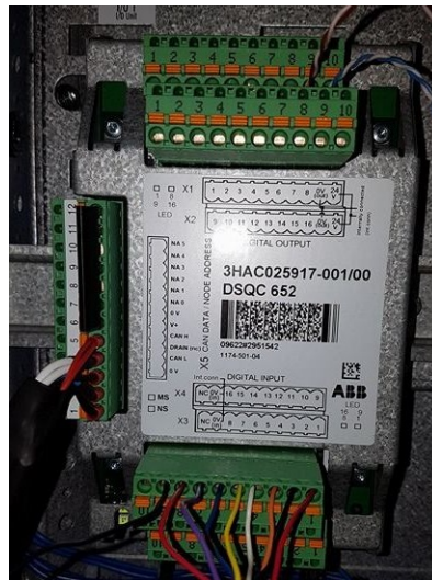
Figura 4.8: Tarjeta de E/S digitales DSQC 652 de la unidad de control IRC5.
