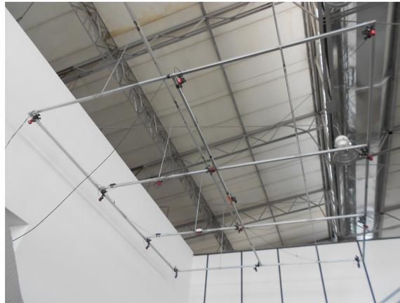
Figura 5.8: Constelación de cámaras para el Sistema *OptiTrack*.
