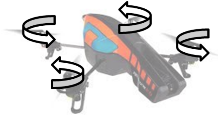
Figura 1.2: Operación del cuadrirotor
