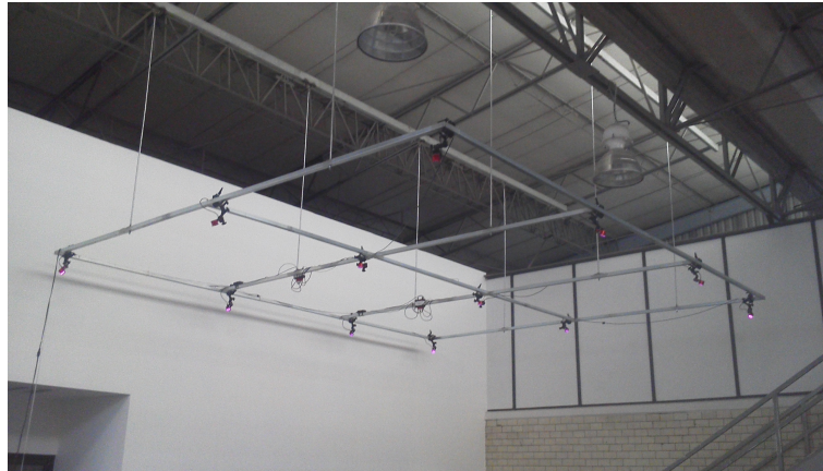
Figura 3.4: Distribución de las cámaras
