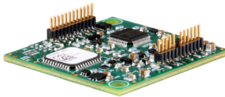
Figura A.1.6: Tarjeta controladora AZB10A4 marca Advanced Motion Control.
