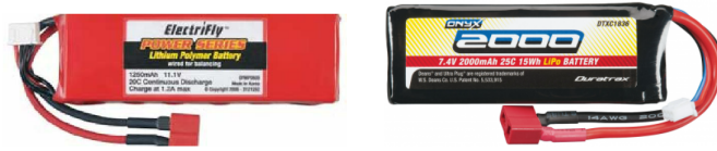
Figura A.1.3: Baterías LiPo usadas en el robot móvil.
