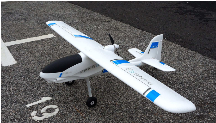
Figura 1.2: Volantex Ranger 757-4, un VANT de ala fija.
