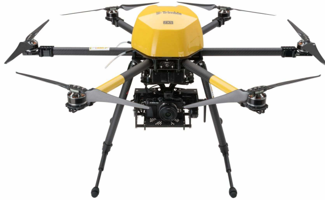
Figura 1.3: El Trimble ZX5, hexacóptero utilizado para mapeo y vigilancia aérea, un VANT de ala rotativa.
