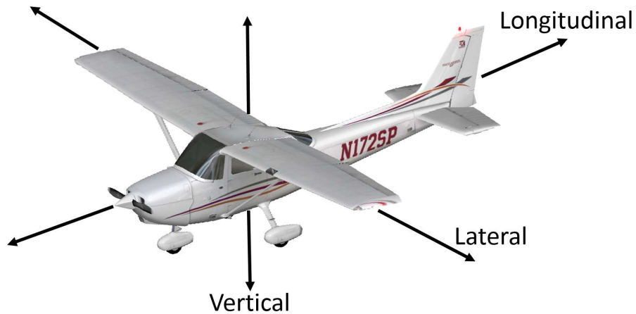
Figura 2.5: Ejes de un aeronave de ala fija
