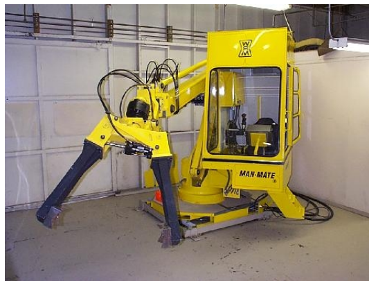
Figura 2.5: Se muestra una máquina MAN-MATE, ejemplo de la teleoperación directa.
