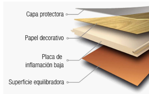
Figura 2.6: Piso laminado constituido de varias capas con láminas de diferentes materiales [8].
