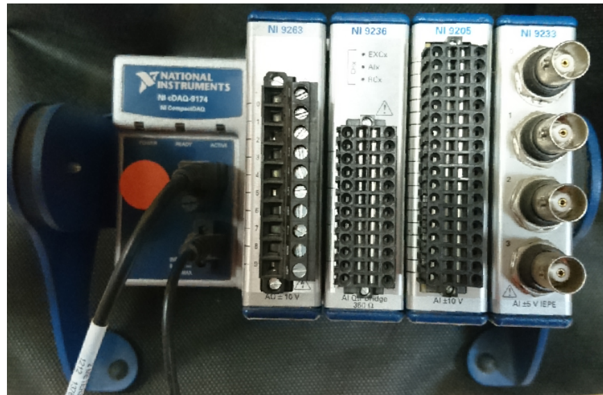
Figura 4.5: Sistema de adquisición de datos NI (C-DAQ) con módulos instalados. De izquierda a derecha NI 9263, NI9236, NI 9205 y NI 9233.
