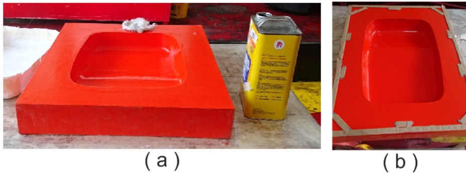
Figura 3.9: (a) Ejemplo de un molde hecho de FV. (b) Molde con sello de bolsa en su perímetro. Molde propiedad de Poliformas Plásticas S.A. de C.V.
