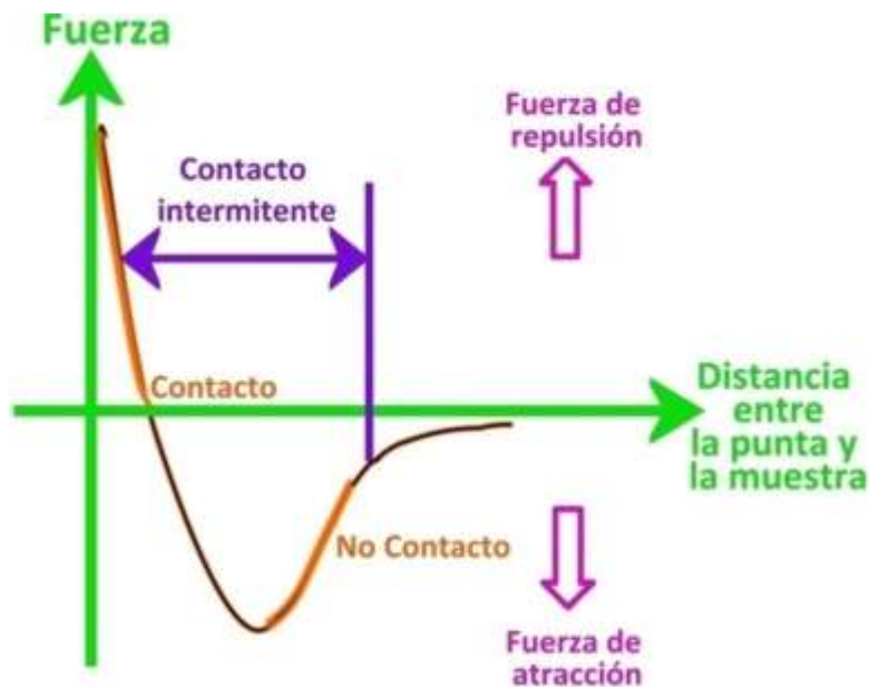
Fig. 2.7.- Gráfica de Fuerza vs distancia entre la punta y la superficie de la muestra. Se muestran las fuerzas de tracción o repulsión que predominan en cada uno de los modos de operación de AFM.
