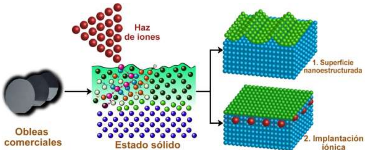
Fig. 2.1.- Representación general del proceso de preparación de las muestras: partiendo de obleas comerciales, se bombardearon con iones a diferentes energías para formar: 1) superficies nano-estructuradas y 2) materiales implantados.
