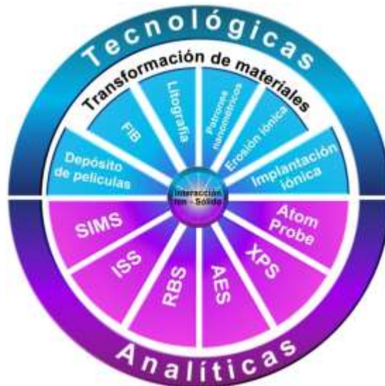
Fig. 1.1.- Clasificación del fenómeno de sputtering con base en su aplicación final. Se muestran los diversos usos de los haces de iones en la ciencia de materiales.
