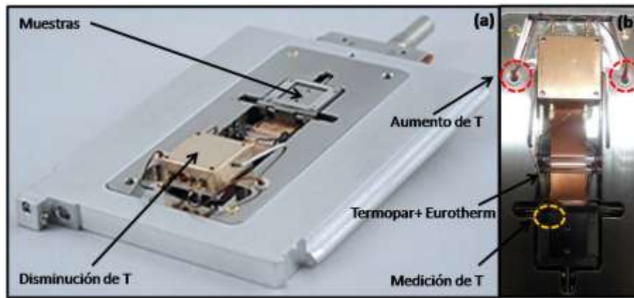
Fig. 2.3.- Porta muestras que permite variar la temperatura. (a) Cuerpo del porta muestras . (b) Magnificación de la zona central donde se encuentra un rectángulo para colocar las muestras, el termopar mide la temperatura en ese punto.
