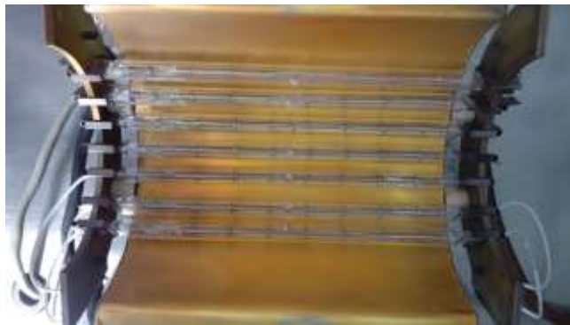
Figura 3.3 Lámparas infrarrojas sobre soporte metálico reflector con sistema de enfriamiento.
