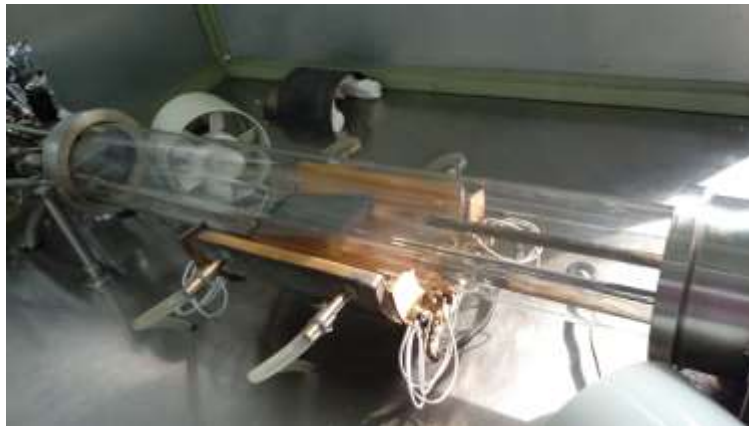
Figura 3.2 Cámara de reacción del sistema LP-MOCVD.
