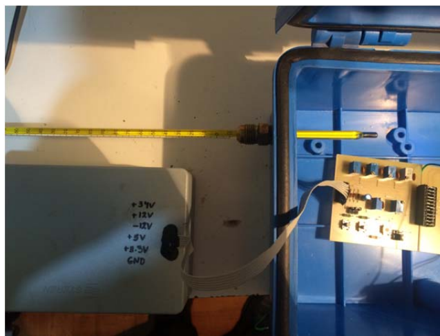
Figura 6.9. Cámara aislada térmicamente, incorporando una celda Peltier para crear un ambiente controlado de temperatura.
