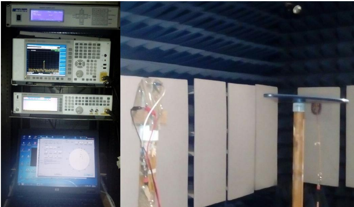
Figura 5.7 Equipo de medición del patrón de radiación y cámara anecoica con la antena patrón y el DUT.
