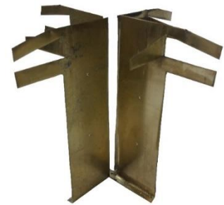
Figura 4. 71 Estructura sobre lámina de latón del radiador de dipolos cruzados con forma de hélice
