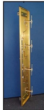
Figura 2. 9 Antena de una estación base: arreglo lineal de 4 dipolos
