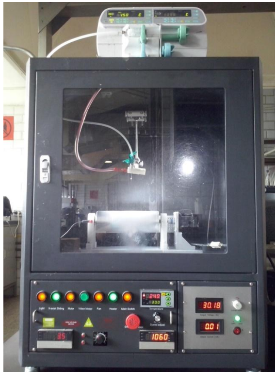
Fig. 13.- Equipo Standard Unit, NEU-01 para la elaboración del composito electrohilado.
