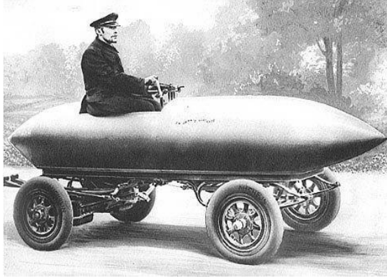
Figura 1.7 En 1899, el famoso piloto Camille Jenatton estableció un nuevo record de velocidad en París a bordo de su descapotable eléctrico con forma de bala, La “Jamais Contente”, fue el primer coche que batió el record de la milla por minuto al alcanzar los 105 kilómetros por hora 26 .
