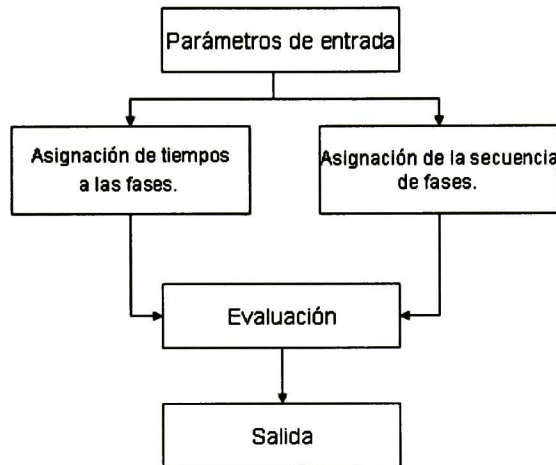
Figura 1.12 Controlador de tráfico urbano.
