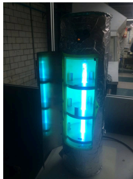
Figura 3.2. Reactor fotocatalítico usado en este trabajo.
