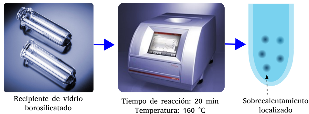
Figura 2.2: Proceso solvotermal asistido por microondas
