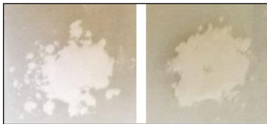
Figura 3.3 Presentación final de la preparación de las muestras de polvo de ZnO para su análisis estructural por difracción de rayos X.
