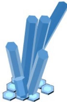
**Fig. 2.7** Nanovarillas de ZnO con diferentes longitudes de crecimiento, aunque en general existe un tamaño promedio, algunos son mayores o menores en longitud al promedio. Puede ser debido a la rugosidad del sustrato y a las diferentes alturas del propio sustrato, que por ejemplo en el caso de los sustratos de vidrio puede ser del orden de unas cuantas micras.
