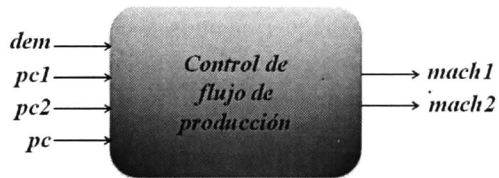
Figura 4.2: Entradas/Salidas del controlador [HJML08]
