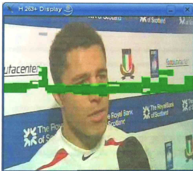
Figura 3.14. Marco P dañado por marco I dañado.
