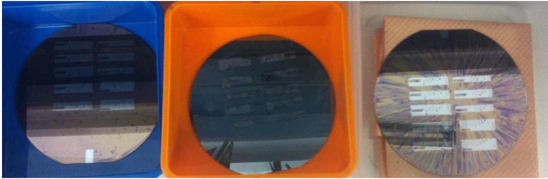
Figura 17.- Obleas de Si con patrones transferidos mediante mascarilla y alineadora.
