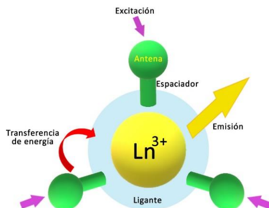
Figura 2. 6 Proceso de sensibilización de un ion \text{Ln}^{3+} a través del "efecto antena".
