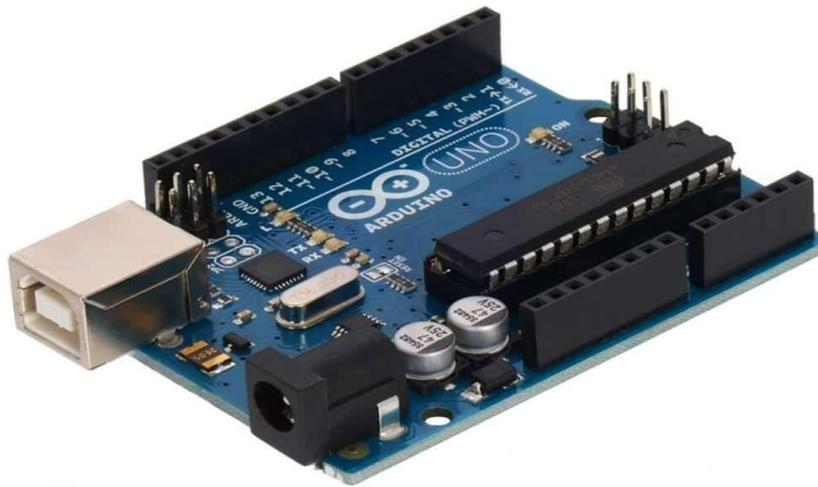
Figura 3.22 Imagen de la tarjeta Arduino UNO empleada como interfaz de comunicación con la PC.
